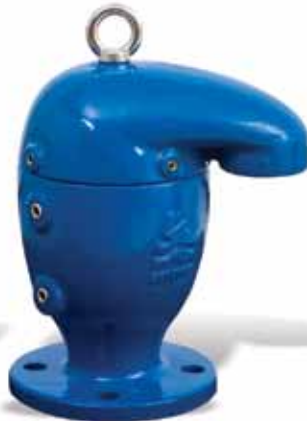
C70 שסתום אוויר משולב, גוף מתכת PN16, 2"-8", DN50-200 יציאה כלפי מטה
